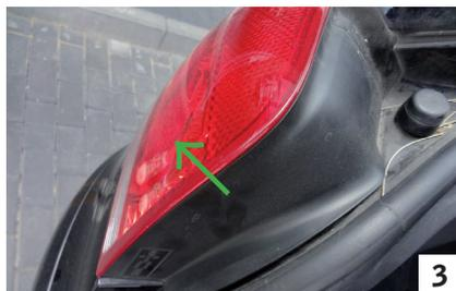
**Bild 3** Rückleuchte von der Innenseite leicht nach vorn ziehen.
