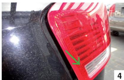
**Bild 4** Drücken Sie nun vorsichtig die Leuchte aus der Karosserie und entnehmen Sie diese.
