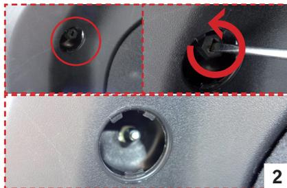
**Bild 2** Lösen und entfernen Sie mit einem flachen Schraubendreher die Befestigungsmutter.
