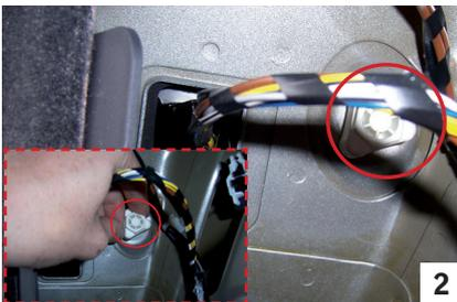
**Bild 2-3** Lösen und entfernen Sie mit einem flachen Schraubendreher die Befestigungsmuttern der Heckleuchte.
