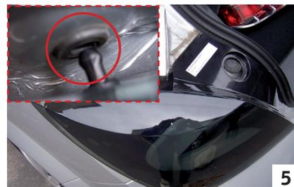
**Bild 4-5** Ziehen Sie die Rückleuchte vorsichtig seitlich nach hinten aus der Karosserie. Beachten Sie dabei bitte die Haltepunkte. / Pull the taillight carefully out of the car body, please take extra care for the 2 holders.
