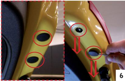
6. Demontieren Sie nun die beiden Abdeckkappen in der Heckklappe.
