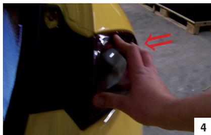
4. Schließen das neue Außenteil und die Rückleuchte nun in umgekehrter Reihenfolge wieder an.
