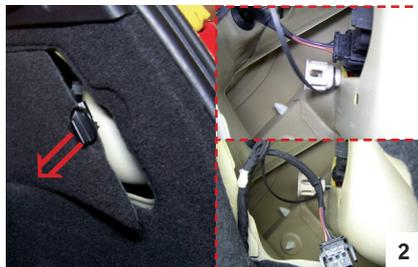
2. Öffnen Sie nun die Wartungsklappe der Außenteile. Lösen und entfernen Sie die Befestigungsmuttern.
