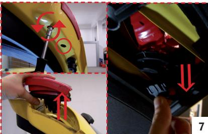
7. Die zwei Befestigungsmuttern M8 lösen und entfernen. Entnehmen Sie das Innenteil nach hinten und lösen Sie die Steckverbindung.
