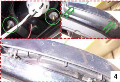
**Bild 4** Zwei Befestigungspunkte, Muttern M8 lösen, Stecker durch leichten Druck auf die beiden Verriegelungsspannen entfernen.
