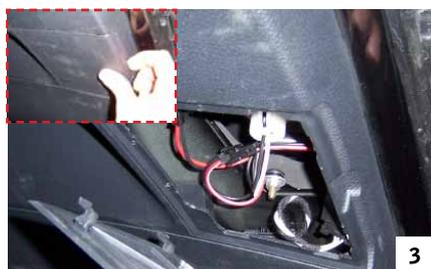
**Bild 3** Serviceöffnung an der Verkleidung der Kofferraumklappe entfernen.
