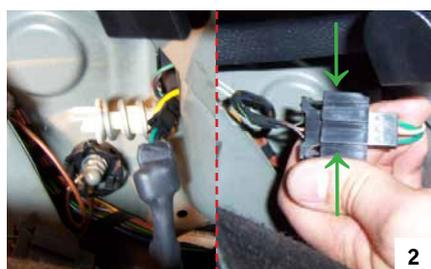
**Bild 2** Rückseitig an Leuchtenaußenteil die Kunststoffflügelmutter lösen, Stecker an Rückseite durch leichten Druck auf die beiden Verriegelungs-spangen entfernen.
