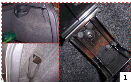
**Bild 1** Seitenverkleidung im Kofferraum demontieren, dazu vorsichtig den Teppich aus der Verkleidung ziehen (links muss zusätzlich der Warn-dreieckhalter abgeschraubt werden).
