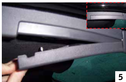
Bild 5 Serviceöffnung an Heckklappe entfernen. Remove service opening in tailgate.
